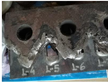
Рис. 1. Ніж для подрібнення відпрацьованих автомобільних шин після 45 дб роботи
