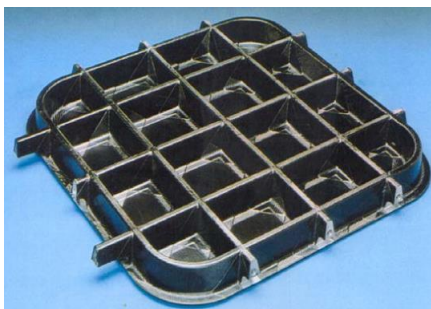
Рис. 2. Вантажні двері з КМ із вбудованими штирьовими замками
