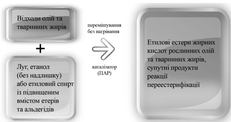
Рис. 1. Умовна схема переробки олієвмісної або жировмісної сировини на біодизельне паливо.
