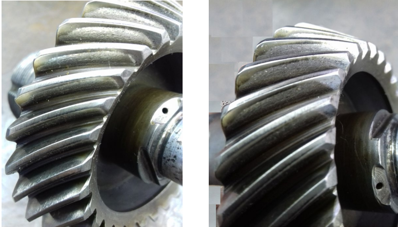
Рис. 2. Утворення пітингу на зуб'ях шестерні приводу коробки агрегатів двигуна Д-36.
