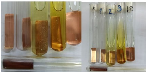
Рис.1. Результати дослідження кислотності на мідній пластинці a – загальний вигляд зразків; б – №1- 100% РТ, №2 – 50% BIOJet+50%РТ, №3 – 100% BIOJet, №K – контроль, №10 – 100% РТ(чисте)
