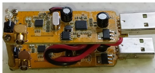
Рис. 3. Радіотракт пристрою з використанням RTL SDR
