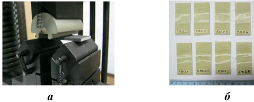
Рис. 3. Вигляд пристосування для випробувань на 4-и точкове згинання (а) та зразків зі склопластику після випробувань (б).
