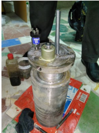
Мал. 2. Підготовка посудини високого тиску для експеримента
